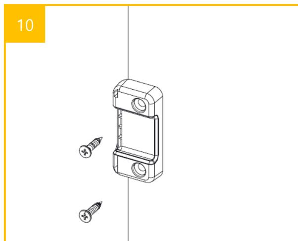
10 Bracket締付穴にスクリーを組み立ててください。
