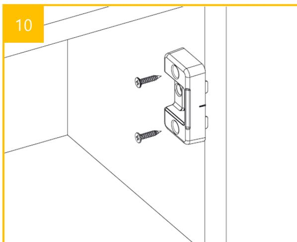
10 Bracket締付穴にスクリーンを組み立ててください。
