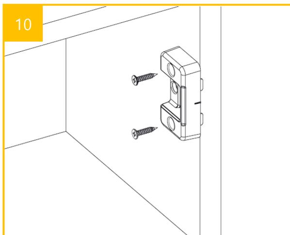
10 Bracket締付穴にスクリューを組み立ててください。
