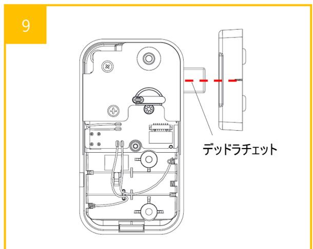
9 Bracketをデッドラチエット中心と一致するように位置させます。
