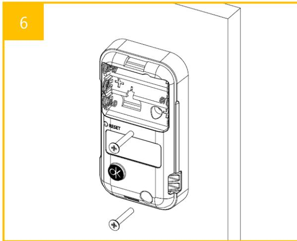
6 FrontとRearをドアに当て、組立ボルトで固定してください。(締付トルク: 電動ドリルの3段階以下)
