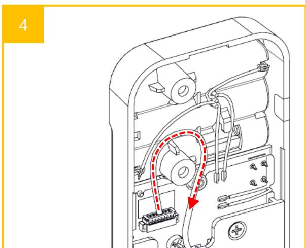
4 ケーブルを図に表記された基準線に沿って整理してください。(製品設置時ケーブル挟まり防止)
