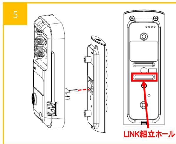
FrontとRearを組み立てる際、LINK組立ホールにRearのLINKを組み立ててください。
