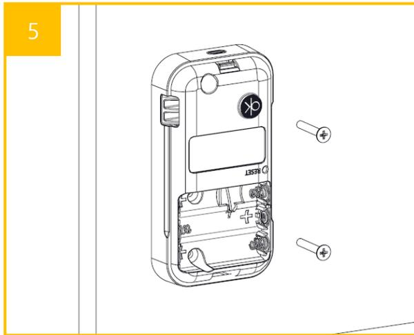
5 FrontとRearをドアに当て、組立ボルトで固定してください。(締付トルク: 電動ドリルの3段階以下)
