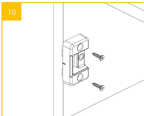
Bracket締付穴にスクリューを組み立ててください。
