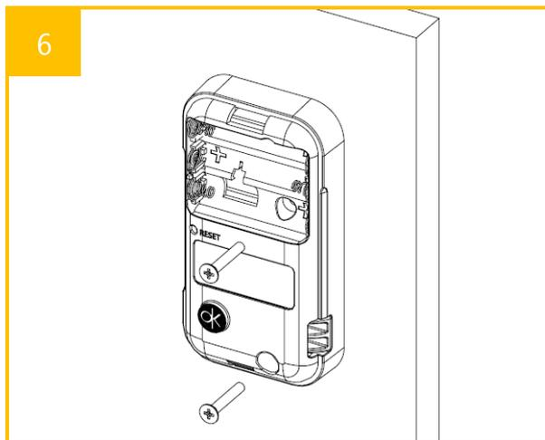
FrontとRearをドアに当て、組立ボルトで固定してください。(締付トルク: 電動ドリルの3段階以下)
