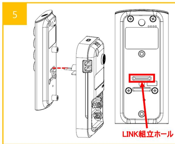
5 FrontとRearを組み立てる際、LINK組立ホールにRearのLINKを組み立ててください。
