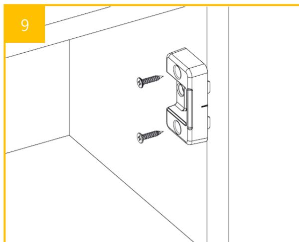
9 Bracket締付穴にスクリューを組み立ててください。
