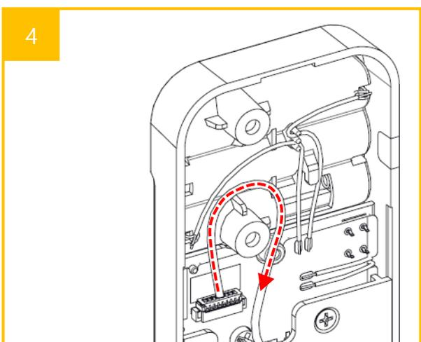
ケーブルを図に表記された基準線に沿って整理してください。(製品設置時ケーブル挟まり防止)
